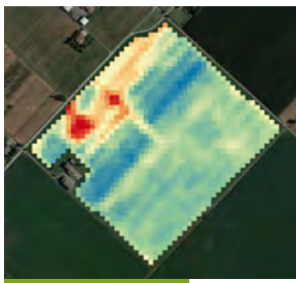
Fig. 1: immagine satellitare del campo prove con indice di vegetazione MSAVI. Da notare la zona rossa che rappresenta la parte di campo che ha subito dei ristagni idrici.
